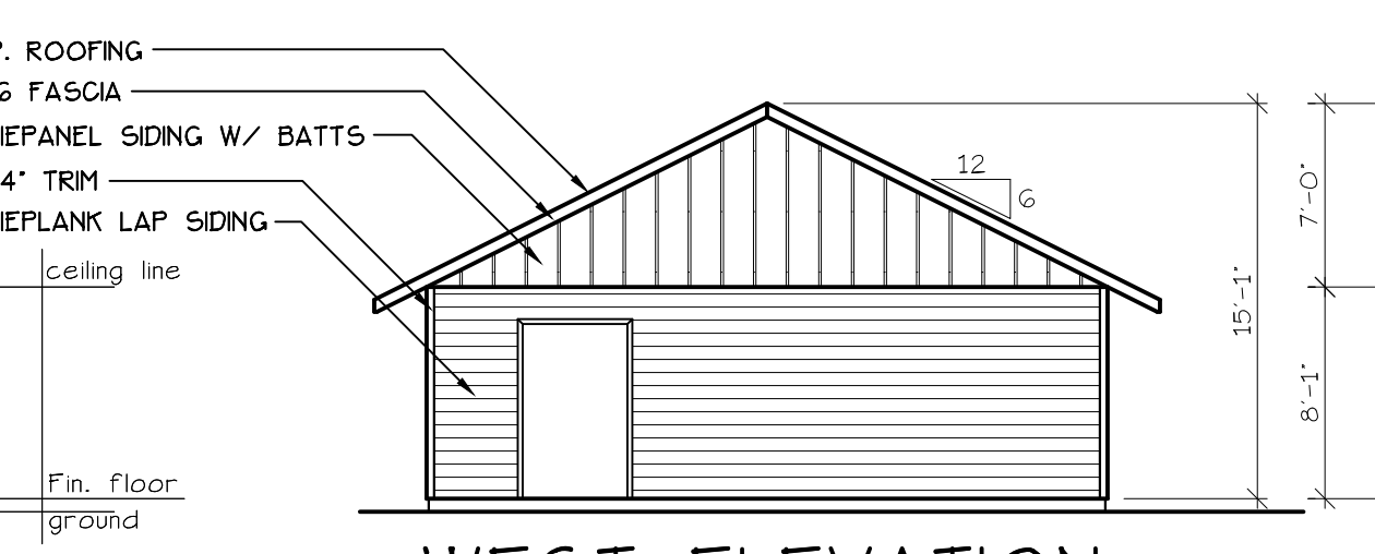
WEST ELEVATION SCALE: 1/8" = 1'-0"
